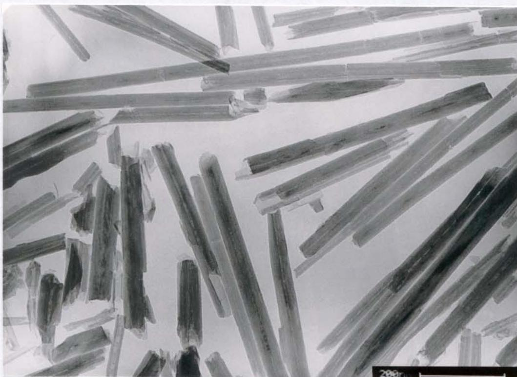
Figura 35. Micrografia eletrônica de transmissão obtida para fibras de crisotila após reação com DBS, sistema com agitação mecânica. (FMC – LME/IF/USP)
