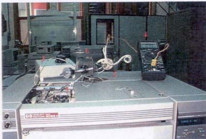
Figura 3.2- Sistema P&T acoplado ao GC-MS. 1- válvula de aço inoxidável; 2-coluna Tenax ® envolvida com fita de aquecimento; 3- varivolt; 4- medidor de temperatura; 5- conexão da válvula no gás de arraste.
