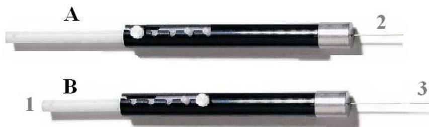
**Figura 4.2.** Representação de um aplicador (*holder*) para SPME, com a fibra retraída (A) e exposta (B).
