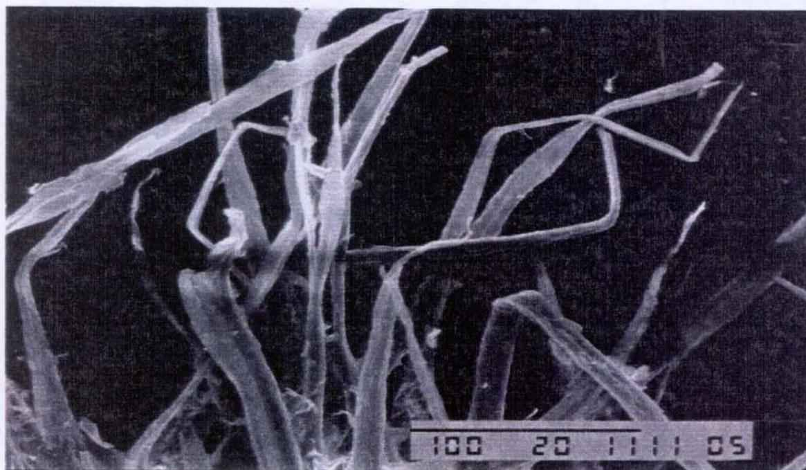
**Figura 7.8** - Fotomicrografia de região de quebra em teste de resistência ao rasgo onde fibra dobrada durante o efino é visualizada. Aumento de 300 vezes, modo de elétrons secundários.
