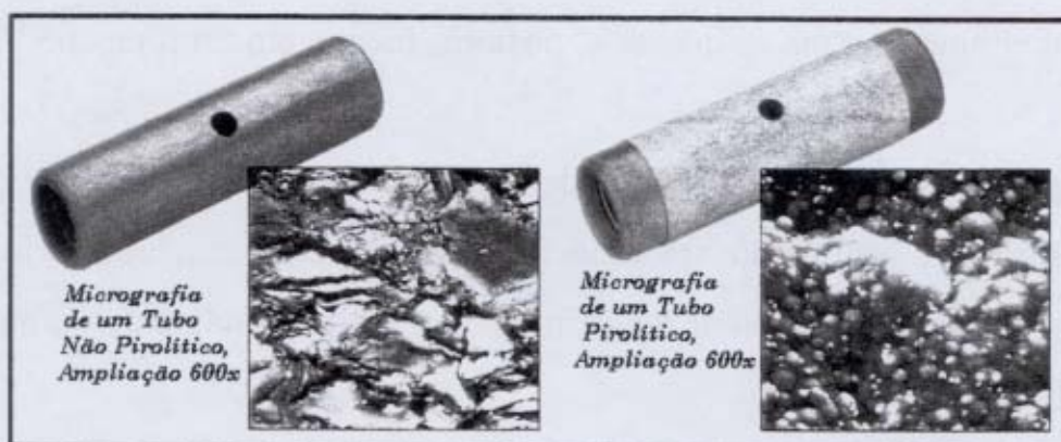
Figura 3.4: Tubos de grafite utilizados para os revestimentos com TaC, fornecidos pela Perkin Elmer [129].
