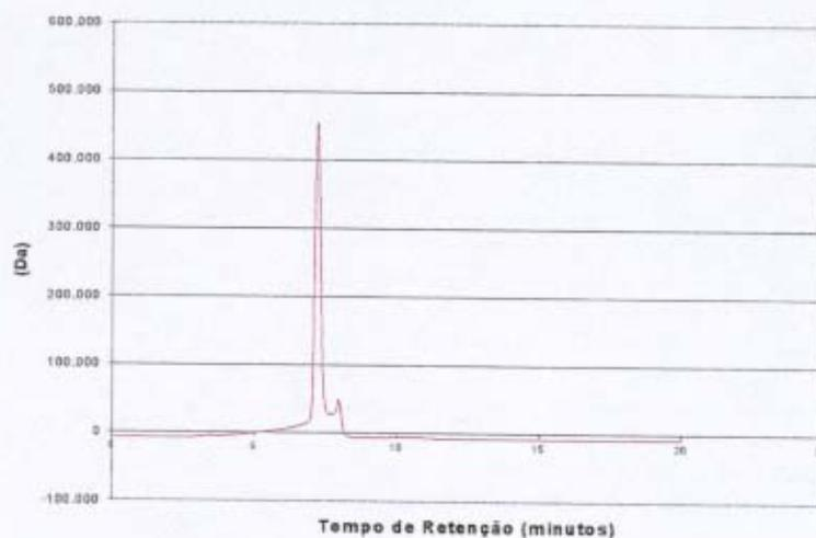
Figura 78. Cromatograma do efluente têxtil após tratamento foto-ozônio-biológico
