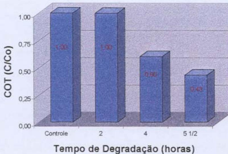
Figura 11. Redução de Carbono Orgânico Total (COT) durante a fotodegradação do efluente têxtil.
