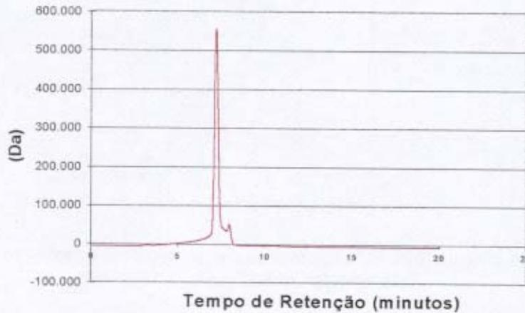
Figura 74. Cromatograma do efluente têxtil após tratamento fotocatalítico
