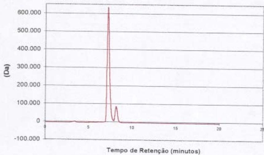
Figura 68. Cromatograma do efluente têxtil antes do tratamento, tempo de retenção da amostra 20 min.
