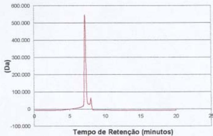
Figura 80. Cromatograma do efluente têxtil após tratamento foto-ozônio-biológico
