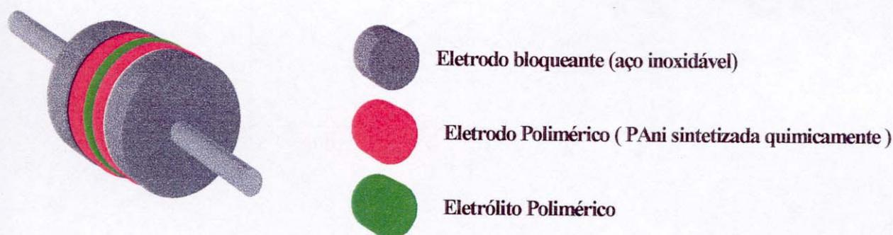
Figura 30 : Esquema da montagem do capacitor.
