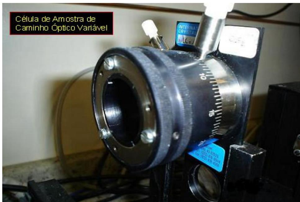
Figura 2.3 – Foto da célula de caminho óptico variável de 0,05 a 5 mm de espessura de amostra.
