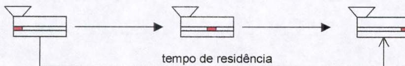
Figura 3.5: Visualização do corante na determinação do tempo de residência
