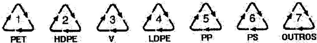
Figura 1.2: O sistema de identificação utilizado no Brasil<sup>10</sup>. Sendo: PET= poli (tereftalato de etileno), HDPE= polietileno de alta densidade, V= poli (cloro de vinila), LDPE= polietileno de baixa densidade, PP = polipropileno e PS = poliestireno.
