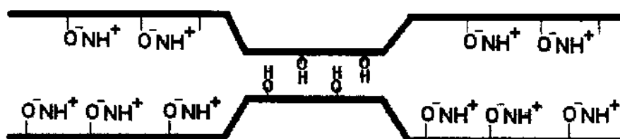
Figura 35 - Representação do processo incompleto de intercalação, onde no interior da lamela existem os grupos remanescentes -OH e aqueles que interagiram com as aminas -O^-NH^+ .
