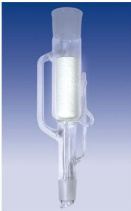
**Figura 7.** Vidraria Soxhlet e sistema utilizado na extração do direcionador por solvente.
