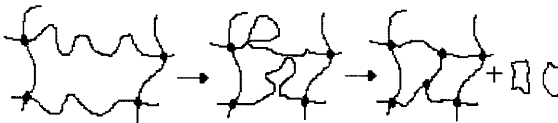
Figura 48. Representação dos rearranjos inter e intra cadeias proposto para o primeiro estágio de degradação da matriz de silicona.
