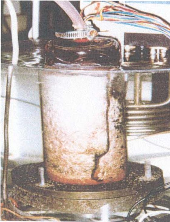
Figura 3.7.a- Reator sendo percorrido por suco de uva, pode-se observar o aproveitamento através das áreas molhadas, e a borra de uva entupindo a base, e entrando pelo canal preferencial da fiação,
