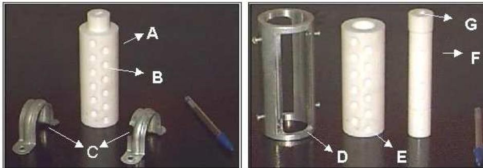
Figura 55: Diferentes vistas da válvula para a mineralização das suspensões, confeccionada em Teflon<sup>®</sup>
