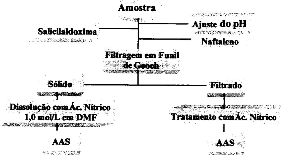
Figura 03: Esquema para separação e determinação de metais utilizando naftaleno microcristalino
