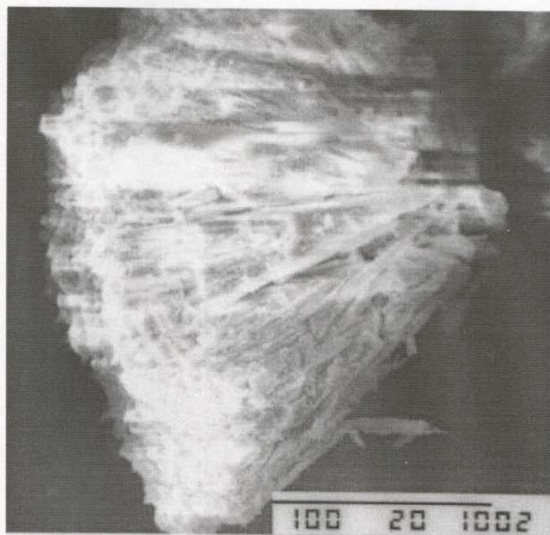
Figura 33: Micrografia de cristalito de CrAPO usado em ensaio de catálise.
