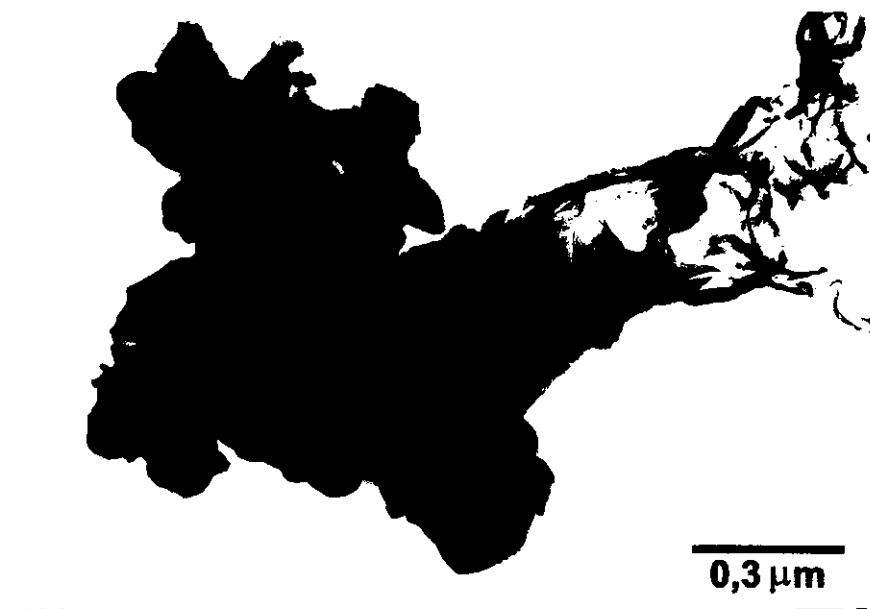
Figura 5.14 - Micrografia eletrônica de transmissão de óxido de ferro revestido com PDMS.
