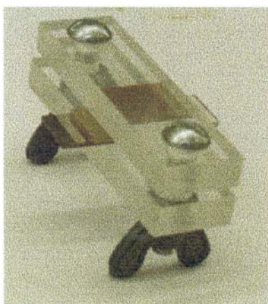
Figura 28. Fotografia do dispositivo sólido em suporte de acrílico com a seguinte configuração simplificada: \text{TiO}_2/\text{corante}|\text{Eletrólito Sólido}|\text{Pt} .
