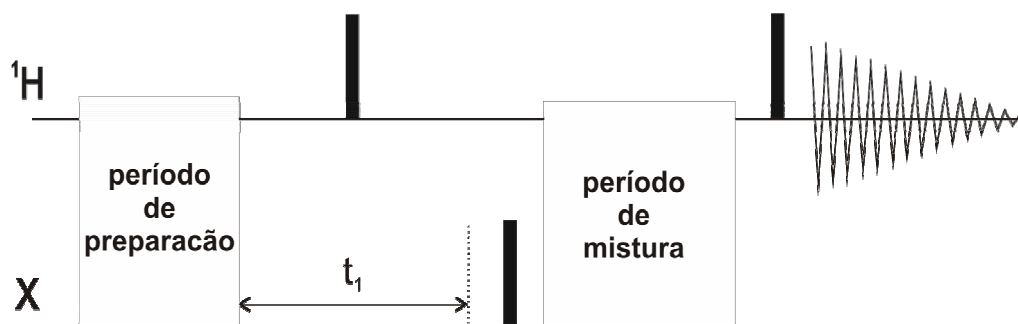
Figura 29. Esquema geral de um experimento de correlação heteronuclear bidimensional sem desacoplamento.
