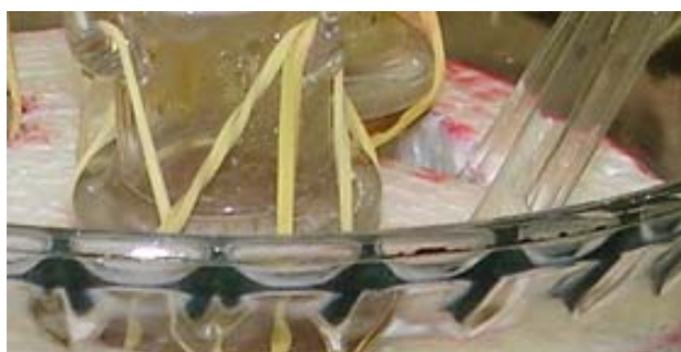
Figura III.1: Célula de difusão de Franz utilizada no experimento de permeação em pele humana abdominal.
