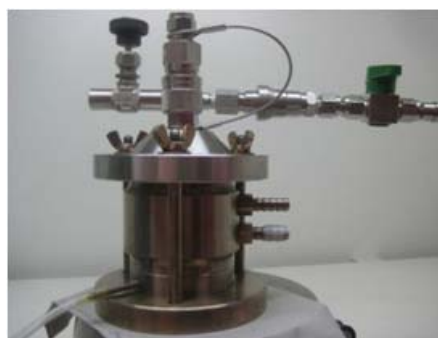
Figura III.2: Extrusora utilizada na permeação em membranas de policarbonato.
