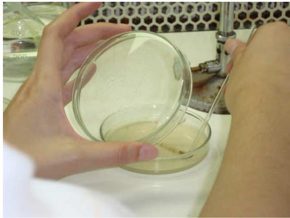
**Figura 16.** Momento do espalhamento de uma alíquota de 0,1 mL de suspensão de solo ao longo da superfície da placa.
