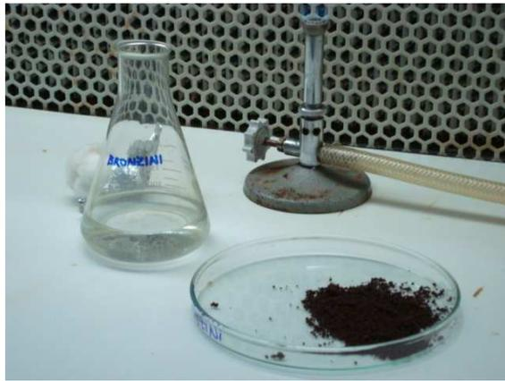
**Figura 14.** Amostra de aproximadamente 10 gramas de solo, pronta para ser adicionada à solução de diluição  $10^{-1}$ .
