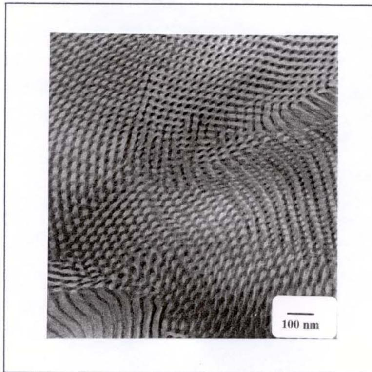
Figura 42 – Micrografia eletrônica de transmissão da blenda 70/30 SBS PAL/hPVME ( $\bar{M}_n = 21,3 \times 10^3$  g/mol).
