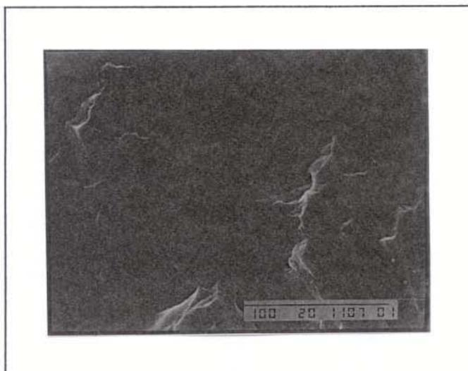
Figura 29 – Micrografia eletrônica de varredura do copolímero tribloco SBS Kraton.
