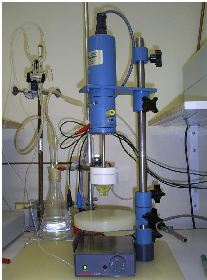
*Figura III.3. Aparelho de rotação controlado, modelo 101 Industrial da Pine Instrumental Company empregado nos estudos cinéticos.*
