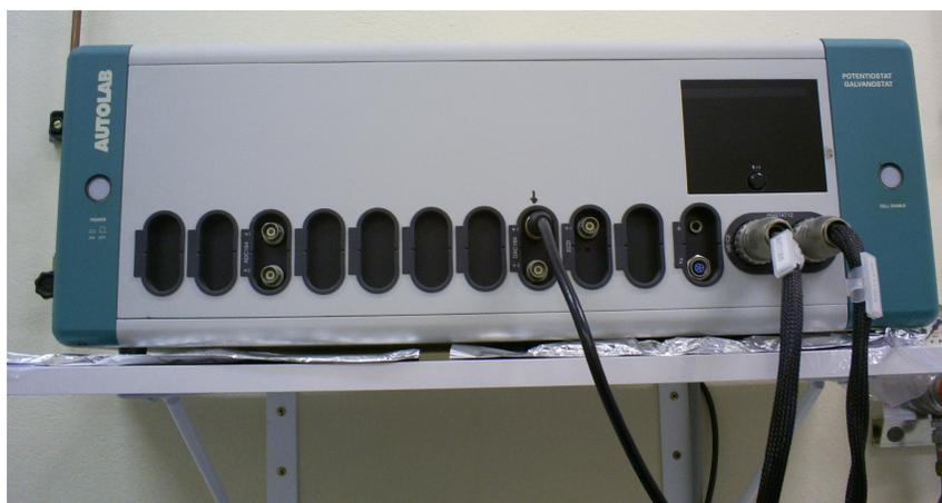
*Figura III.4. Fotografia de um potenciostato, modelo PGSTAT-30 da Autolab Eco Chemie.*
