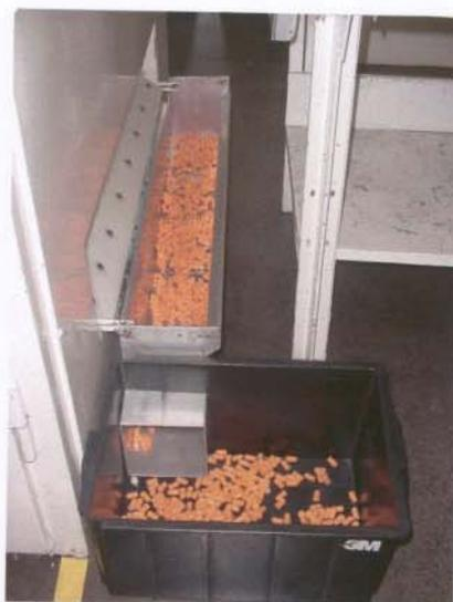
**Figura 7:** Amostras de protetores auditivos coletadas após o processo de desmoldagem e abertura mecânica das células
