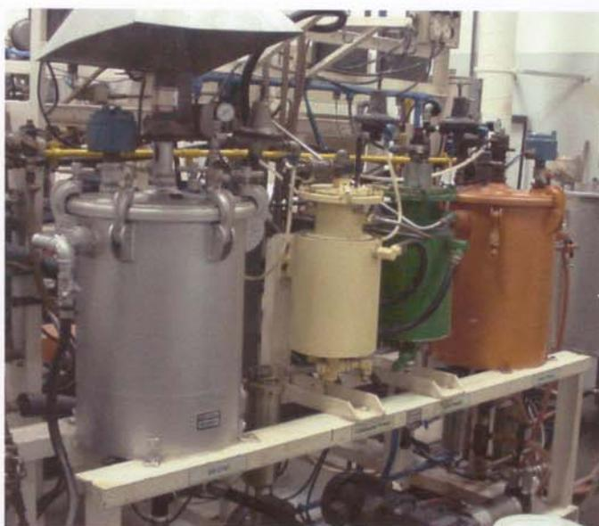
**Figura 4:** Tanques que armazenam os reagentes ou mesmo as pré soluções utilizadas na produção da espuma
