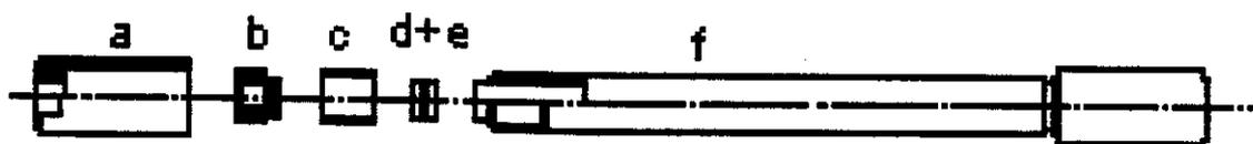
Figura 9 - Coluna Cromatográfica e Conexões utilizadas (a = Porca Terminal, b = Redutor, c = tubo de alinhamento, d = filtro, e = anel de PEEK, e, f = Corpo da Coluna)
