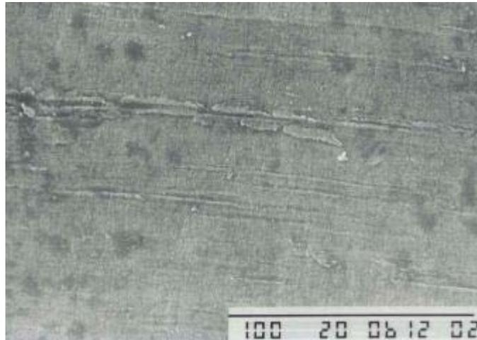
Figura 69: Micrografia da superfície interna de um tubo de Ni 201 novo (aumento de 500x). Na legenda no canto inferior esquerdo temos: a escala utilizada, onde o traço negro corresponde a 100  $\mu\text{m}$ , em seguida temos a aceleração de voltagem (20 KV), a data de obtenção da micrografia (12 de Junho) e a seqüência da micrografia (segunda a ser obtida).
