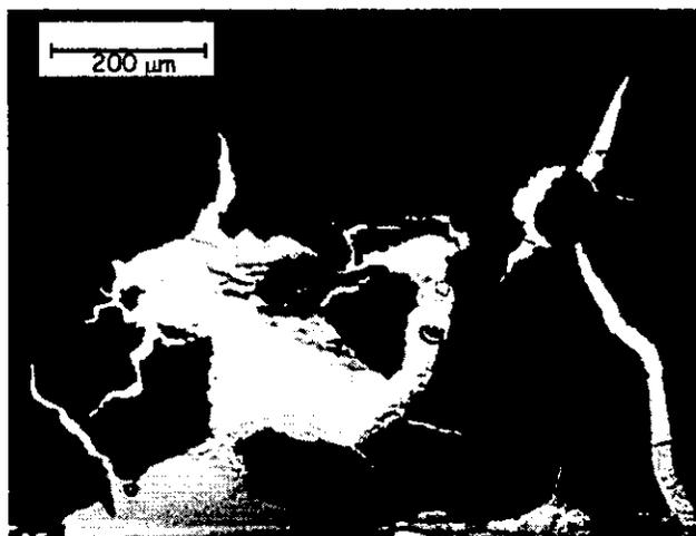
Figura 4.10: Micrografia do filme de poli(12-MFDDT) obtido através de deposição potencioestática,  $Q_{dep} = 255 \text{ mC cm}^{-2}$  mostrando as rachaduras apresentadas pelo filme.
