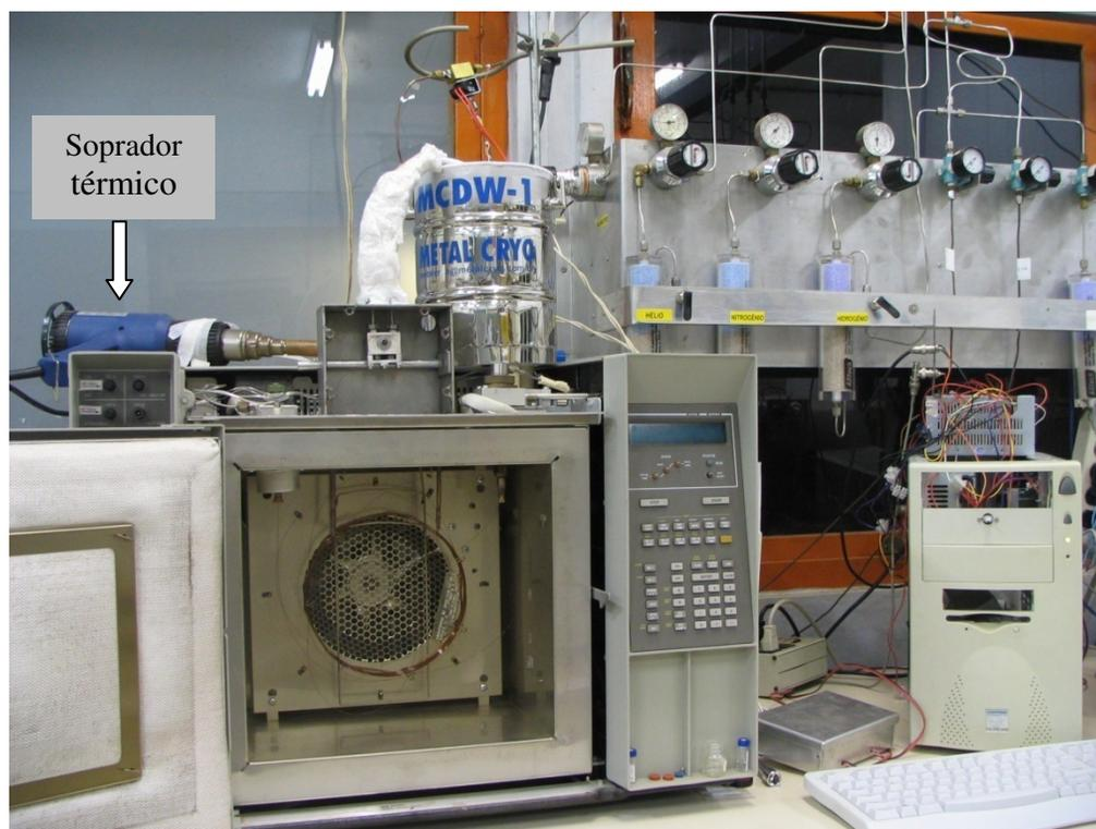
**Figura 25.** Sistema GC×GC completo, com modulador de duplo jato e  $N_2(l)$  como fluido criogênico e cabeçote em peça única (segunda versão projetada). O compartimento modulador é mostrado em mais detalhes na Figura 22.
