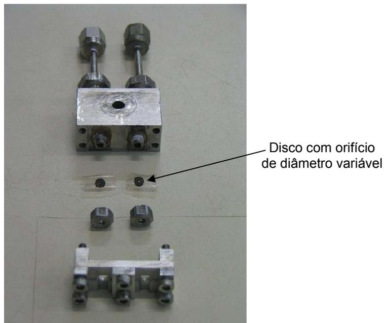
**Figura 23.** Cabeçote desmontado do modulador da segunda versão.
