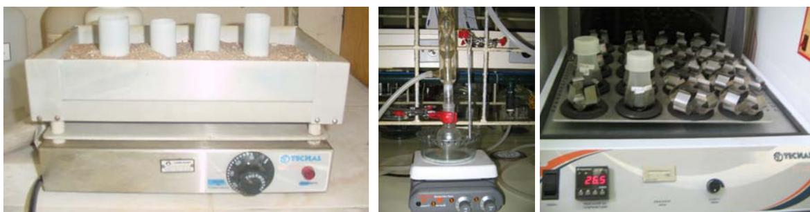
**Figura 21:** **A** - Banho de areia com cadinhos de teflon. **B** - Sistema de refluxo para HCl. **C** - Mesa para a agitação para extração com HF.
