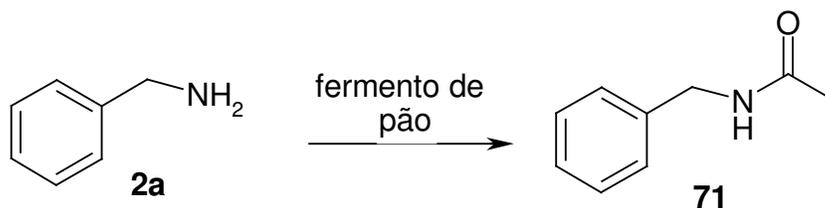
**Esquema 22:** Acetilação da benzilamina em presença de fermento de pão.
