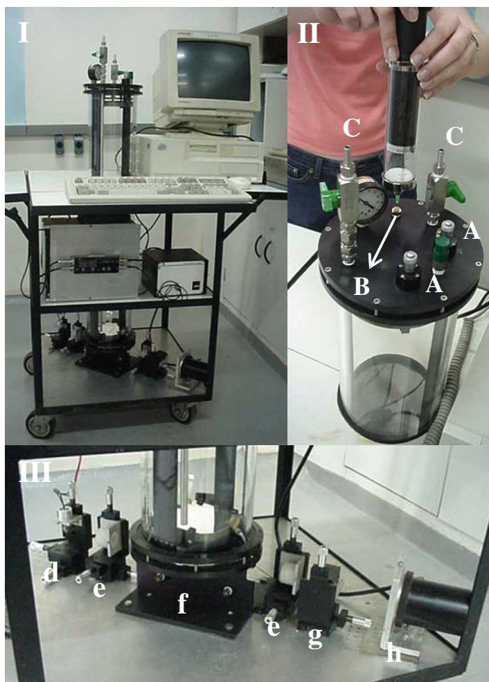
Figura 3. I) Vista geral do espectrofotômetro de infravermelho próximo. II) Parte superior da célula de medida, mostrando o momento de injeção da amostra; A) Parafusos micrômetros para ajuste do caminho óptico da célula de múltiplas reflexões; B) Septo para introdução da amostra; C) Válvulas de entrada e saída para a limpeza da célula (purga). III) Parte óptica do instrumento (detalhada na Figura 2).
