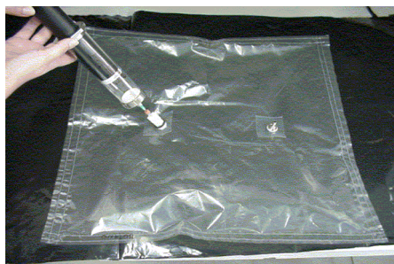
Figura 6. Procedimento de coleta do gás puro com auxílio de seringa a partir da bolsa de amostragem.
