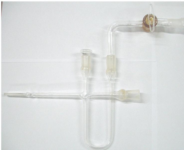
**Figura 12.** Cella utilizada para os estudos espectroscópicos de absorção na região do UV-vis-NIR
