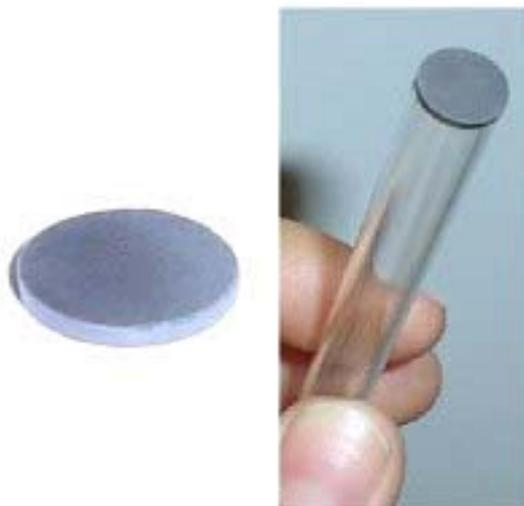
**Figura III.2** – Fotos da pastilha e o do eletrodo de trabalho montado após a fixação da pastilha no tubo de vidro.
