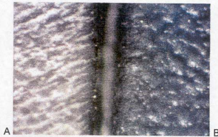
Figura 43 – Amostras sem aditivos controle (B) e envelhecida por 514 h (A) em Weatherometer (face exposta à luz).
