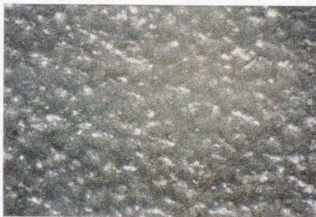
Figura 47 – Amostra com aditivos envelhecida por 3008h em Weatherometer (face não exposta à luz).
