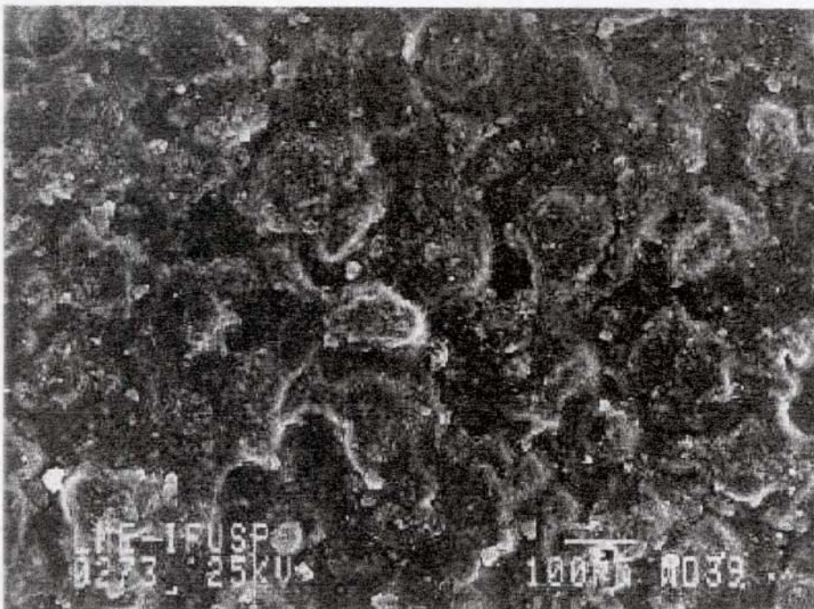
Figura 30 - Micrografia da face exposta à luz da amostra com aditivos envelhecida por 514 h em Weatherometer .
