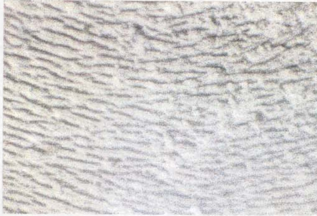
Figura 45 – Amostra sem aditivos envelhecida por 3008 h em Weatherometer (bico de injeção da face exposta à luz).
