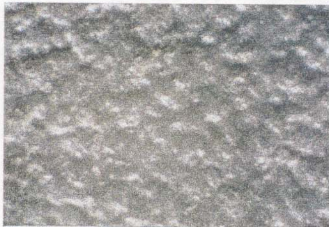
Figura 46 – Amostra com aditivos envelhecida por 3008 h em Weatherometer (face exposta à luz).
