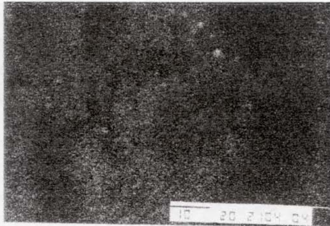
Figura 37 – Imagem de retroespalhamento obtida em microscópio eletrônico de varredura da amostra sem aditivos envelhecida por 3008 h em Weatherometer (face exposta à luz).
