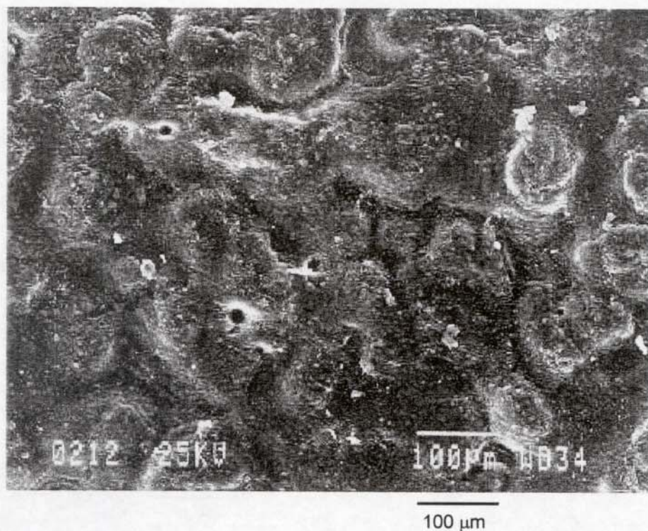
Figura 32 - Micrografia da face não exposta à luz da amostra sem aditivos envelhecida por 514 h em Weatherometer .
