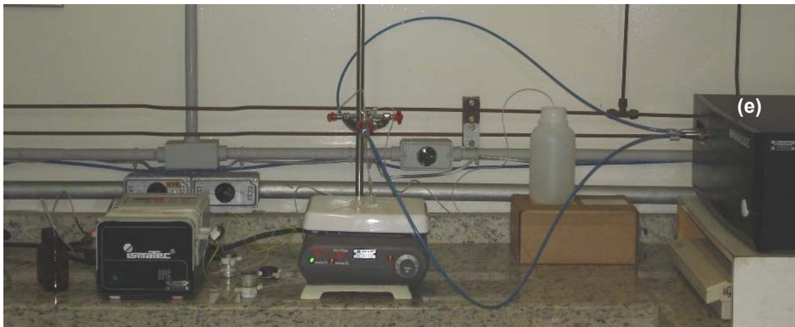
**Figura I.6.** Foto geral do sistema de perturbação de concentração em fluxo. (a) bomba peristáltica, (b) válvulas solenóides, (c) câmara de mistura dos reagentes, (d) célula de detecção, (e) espectrofotômetro NIR Brimrose.
