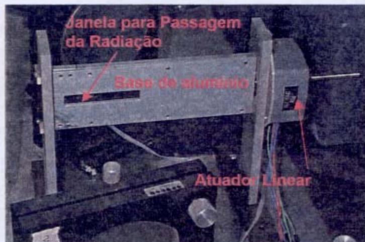
Figura II.6. Foto do dispositivo posicionador da máscara de Hadamard.
