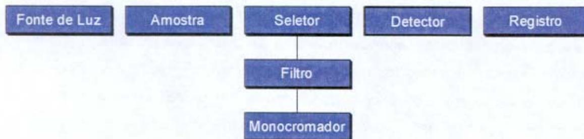
Figura I.3. Diagrama em bloco de um instrumento para espectroscopia óptica.
