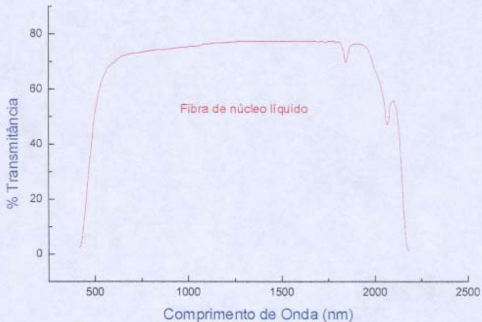
Figura II.27. Espectro de transmitância da fibra de núcleo líquido (Lumatec) utilizando como fonte uma lâmpada de tungstênio (Espectro digitalizado do catálogo do fabricante).
