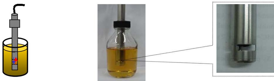
Figura 20: Esquema e foto da sonda de transflectância.
