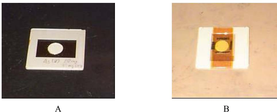
**Figura 21-Pastilha de sílica zirconizada (A) e a pastilha no suporte usado para a análise de XAS**
