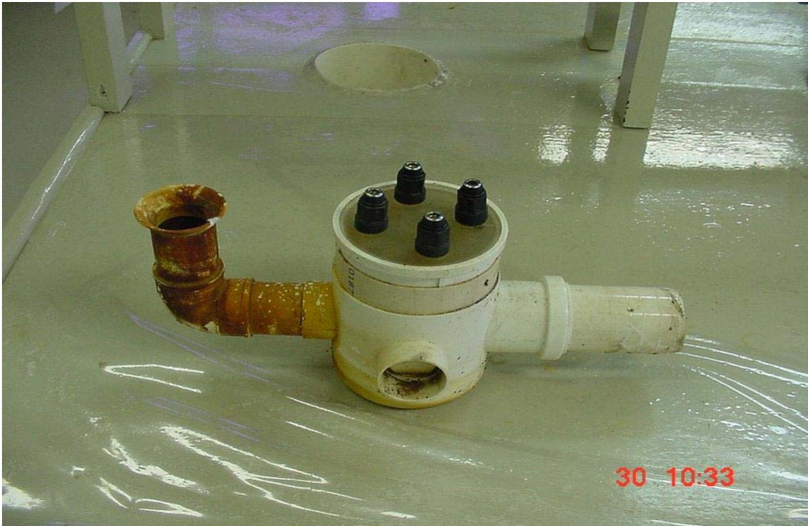
**Figura 4.1: foto da caixa sifonada (porta-eletrodos) utilizada na monitoração em contínuo**
