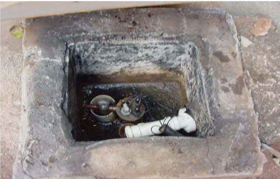
**Figura 4.2: foto do dispositivo utilizado na monitoração em contínuo (caixa sifonada dentro da caixa de inspeção dos efluentes de laboratório)**
