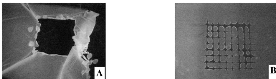
**Figura 3.3.2.3.** Filmes de FBAPP razão  $m_{\text{NaPP}}/m_{\text{FBA}}$  0,4, após a marcação de uma graticula e imersão do filme em  $\text{NaOH}$   $0,1 \text{ mol.L}^{-1}$  (A) e  $\text{HCl}$   $0,1 \text{ mol.L}^{-1}$  (B) durante 24 horas.
