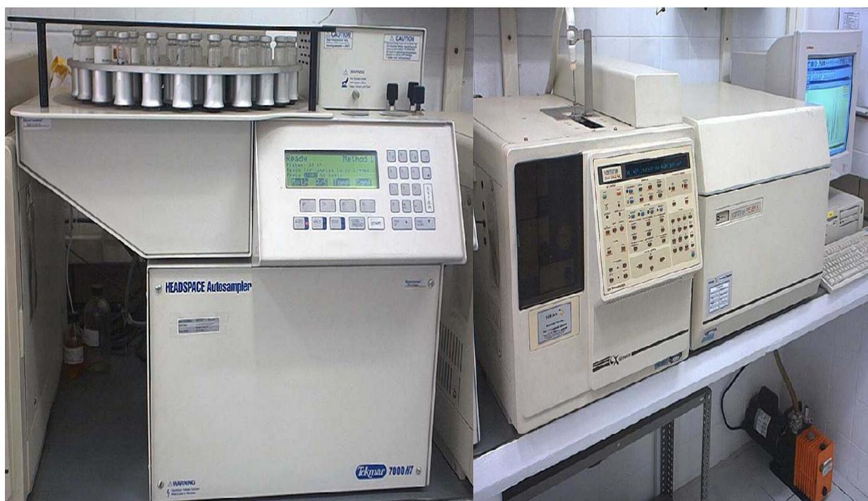
**Figura 9. Amostrador “headspace” Tekmar (esquerda) e Cromatógrafo GC/MS Varian 3400 Cx/Saturn III (direita).**
