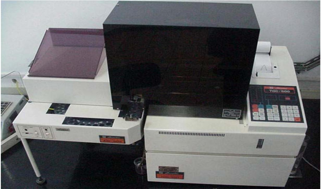
**Figura 6. Analisador de TOC Shimadzu TOC-500**
