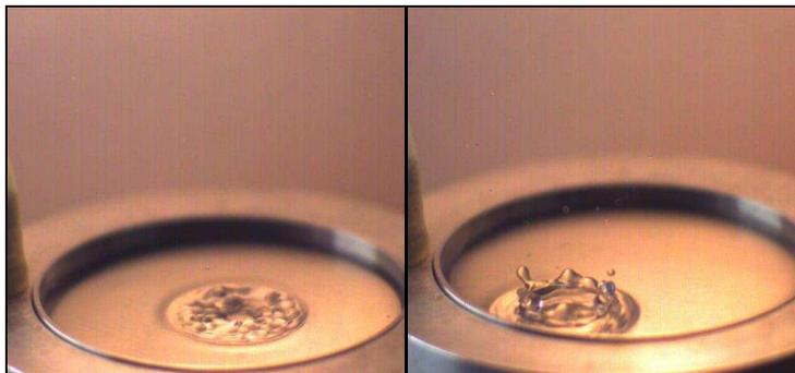
Figura 15. Comparação entre as estruturas de impacto produzidas em água (esquerda) e na solução de PEO (direita), 40 ms após o impacto da gota.
