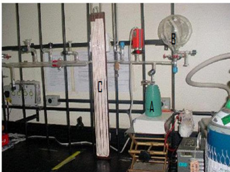
Figura 2. Aparelho utilizado para medidas de S_{BET} e distribuição de poros.
