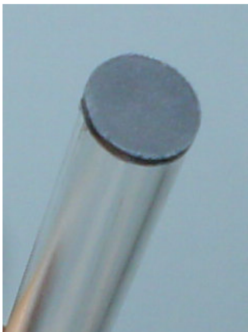
Figura 3. Eletrodo confeccionado em forma de disco.
