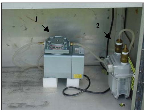
Figura 5: Foto do sistema de amostragem de mercúrio particulado em Piracicaba (SP): 1) bomba de sucção e 2) gasômetro.
