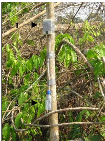
Figura 8: Foto do sistema de amostragem de mercúrio atmosférico em Alta Floresta (MT): 1) bomba de sucção e 2) coluna de ouro e garrafa PET
