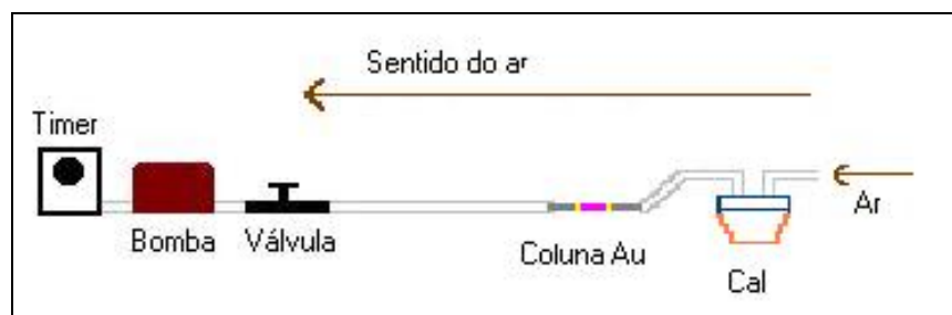
Figura 4: Esquema do sistema de amostragem de mercúrio gasoso utilizado em Piracicaba (SP).
