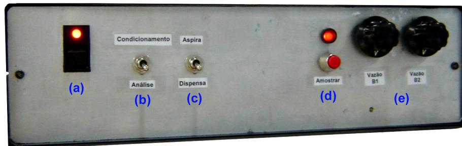
**Figura B 10:** Painel frontal do módulo controlador proposto. Chave de energia (a), chave “condicionamento/análise” (b), chave “aspira/dispensa” (c), chave “amostrar” (d) e potenciômetros para ajuste das vazões das mini-bombas (e).
