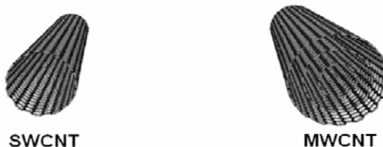
**Figura I.3.** Nanotubos de paredes simples (SWCNT) e nanotubos de paredes múltiplas (MWCNT).
