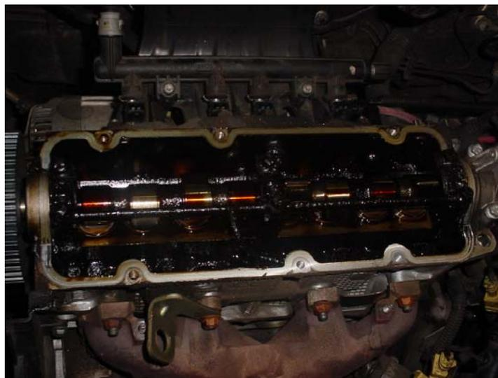
**Figura 16.** Motor automotivo danificado pelo uso de lubrificante degradado.
