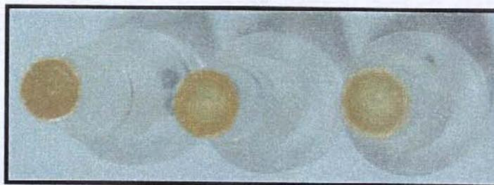
**Figura 40.** Fotografias de fases sensoras, da esquerda para a direita uma fase sensora que não foi utilizada; uma fase sensora utilizada para a inserção de 50 ppm<sub>v</sub> de NO<sub>2</sub> e 500 ppm<sub>v</sub> NO<sub>2</sub>.
