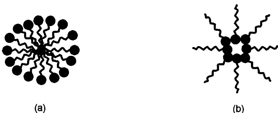
Figura II.3: Esquema representativo de uma micela normal (a) e reversa (b).
