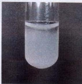
**Figura 29.** Precipitado obtido após adição de solução de cloreto de bário a uma solução contendo íons sulfato.
