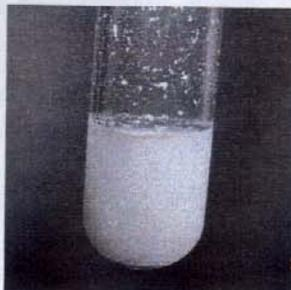
**Figura 28.** Precipitado obtido pela adição de solução de nitrato de prata à solução contendo íons  $\text{Cl}^-$ .
