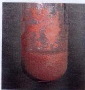
**Figura 26.** Precipitado obtido pela adição de solução de dimetilglioxima à solução contendo íons  $\text{Ni}^{2+}$ , ligeiramente alcalinizada com solução de amônia.
