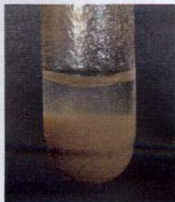
**Figura 25.** Precipitado obtido pela adição de solução de amônia a uma solução contendo os íons  $\text{Al}^{3+}$ ,  $\text{Fe}^{3+}$  e  $\text{Cr}^{3+}$ , em presença de cloreto de amônio.
