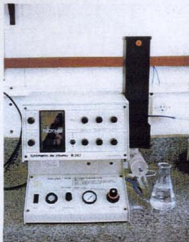
**Figura 31.** Fotômetro de chama Micronal, modelo B 256, usado para determinação de sódio e potássio em amostra de lodo obtido da ETE de Jundiaí.
